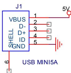
如果 USB 供电不足，可以通过一条 mini USB 线连接辅助供电口与主机 USB 接口提供额外的供电。
