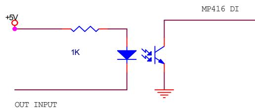
以为 MP4624 的 DI 输入内部有上拉电阻，因此光耦的输出不用加入上拉电阻。
